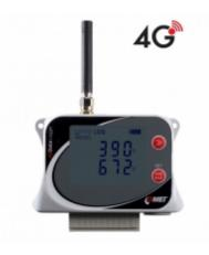
Rejestrator jest przeznaczony do rejestracji temperatury z trzech termopar, jednej zewnętrznej sondy Pt1000 i jednego wewnętrznego czujnika temperatury. W razie przekroczenia ustawionych limitów, mogą zostać wysłane wiadomości SMS i JSON za pomocą połączenia komórkowego 4G. Mierzone wartości mogą być gromadzone w internetowej bazie danych tj. <u>chmurze COMET</u>, która jest kompletnym systemem monitoringu, alarmowania i analizy.
